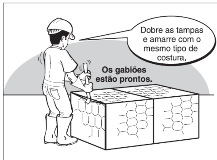
Figura 10.6 – Fechamento do gabião caixa
